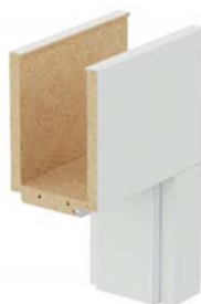
профил на каса – лйсна 80 mm за височина на вратата 2,0 – лйсна 100 mm за височина на вратата 2,2
