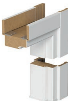
100 мм, в синтетично покритие (с плоски декоративни первази, които се свързват под ъгъл 90°) или във фурнир (с плоски декоративни первази, които се свързват под ъгъл 45°)
