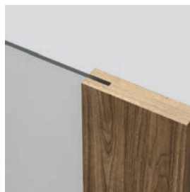
свързка с прави ръбове на крилото със стъклото безфалцово крило
