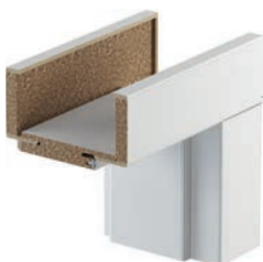
профил на касата – перваз 80 мм за височина на вратата 2.0 – перваз 100 мм за височина на вратата 2.2
